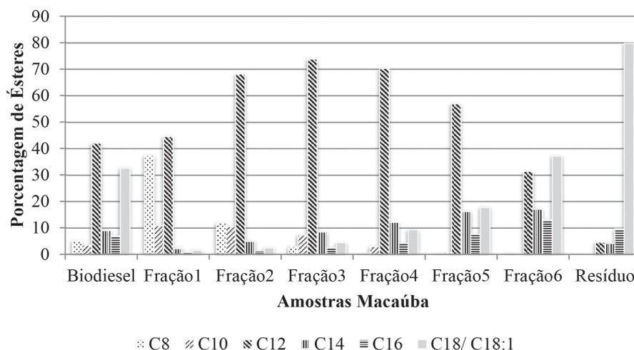
**Figura 2.** Teor de ésteres das frações destiladas do biodiesel de óleo de amêndoa de macaúba**Tabela 3.** Massa específica a 20 °C, volume e balanço de massa para o biodiesel de amêndoa de macaúba, frações destiladas e resíduo
