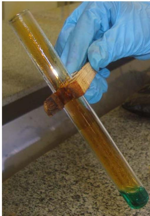
*Figura 2S. Fotografia ilustrativa da dissolução de uma amostra de bijuteria (peça 07-00), para sua classificação quanto ao tipo de liga*
