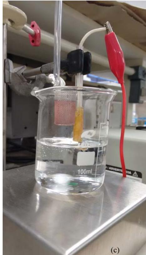
**Figura 4S.** Fotografias do aparato utilizado para realização da análise eletrogravimétrica da amostra de uma bijuteria (liga) contendo cobre: (a) e (b). Fotografia destacando o cátodo de rede de platina, no final da eletrólise, com todo o cobre já depositado (c)
