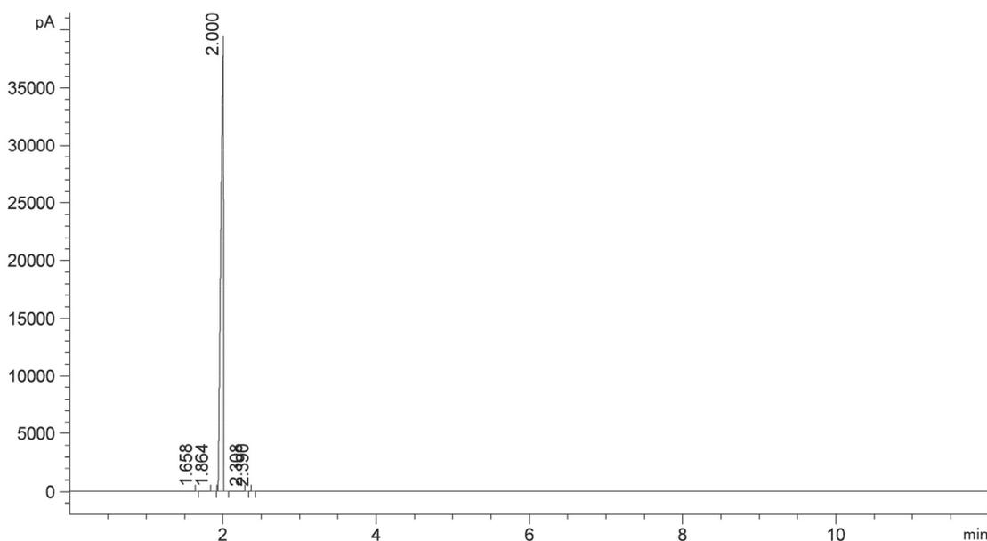
**Figura 4.** Cromatograma de acetona P.A.-A.C.S nas condições definidas (Coluna HP-INNOWAX, 30 m x 0,25 mm, espessura do filme de 0,15 µm; fase móvel: nitrogênio a 1,5 mL.min<sup>-1</sup>; temperatura do injetor: 200 °C; temperatura da coluna: 40 °C por 2 minutos a 190 °C a 15 °C min<sup>-1</sup>; detecção por ionização em chama, 300 °C)
