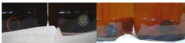
Figura 3S. Aspecto do polo negativo de pilhas Zn-C I expostas à ação do chorume após 7 dias (esquerda) e 30 dias (direita)
