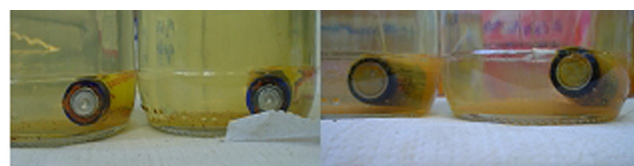
Figura 2S. Aspecto do polo negativo de pilhas Zn-C I expostas à ação da água da chuva após 7 dias (esquerda) e 30 dias (direita)
