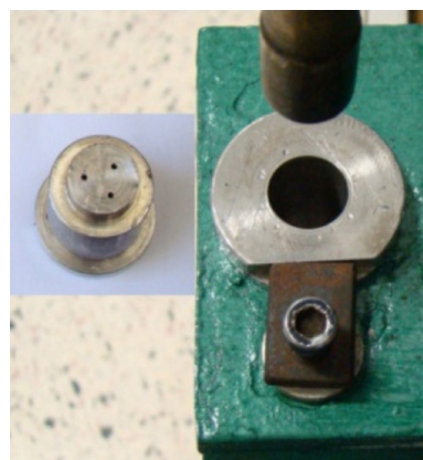
Figura 3S. Detalhe do sistema êmbolo/cilindro de molde/trava
